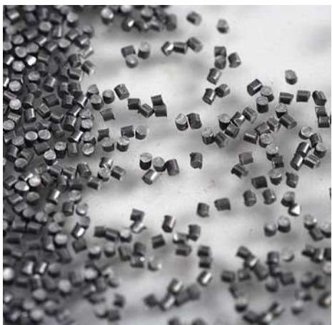
Les grenailles sont propulsées à grande vitesse lors du grenaillage et sablage. Il existe différents types de grenailles pour chaque application. Les billes de fil coupé et de fonte peuvent être utilisés pour le grenaillage de pré-contrainte et le nettoyage par sablage, tandis que les grenailles en plastique et grit sont utilisés pour le nettoyage de surface uniquement. Nous proposons une vaste gamme de taille de billes. Nous fournissons également des diamètres personnalisés sur demande.
